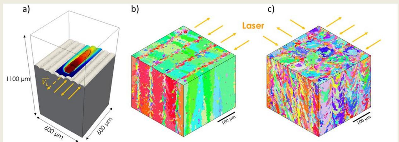
Figure : a) Simulation du procédé FA FLLP, par translation du champ thermique stationnaire et microstructure associée simulée par approche CAFE. Deux trajectoires sont considérées : b) trajectoire aller-retour sans modification des directions de parcours et c) rotation de 90° des directions de parcours entre couches consécutives (Doctorat T. Camus) [4].
