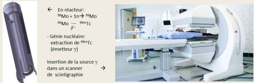
Figure 2 : application à la fabrication du radio-traceur <sup>99m</sup>Tc. A gauche : Cœur du réacteur nucléaire FRMII dans lequel sont montées les plaques. A droite : un scanner de scintigraphie.
