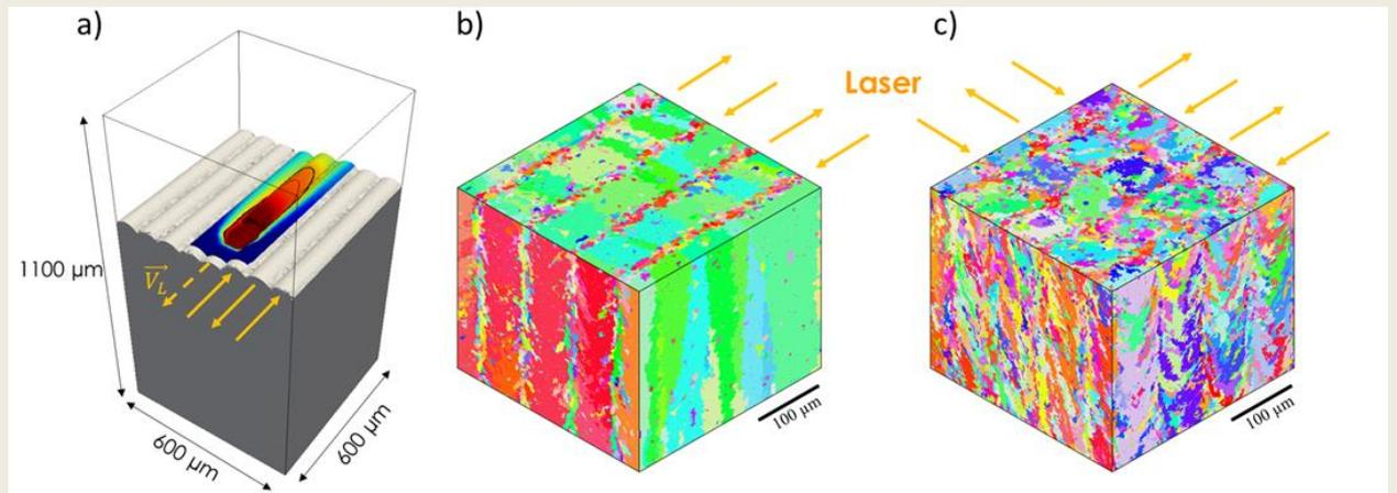
Simulation du procédé de fabrication additive FLLP par a) une stratégie de translation du champ thermique stationnaire et structures de solidification associées à b) une trajectoire aller-retour sans modification des directions de parcours et c) trajectoire avec rotation de 90° des directions de parcours entre couches consécutives [4].
